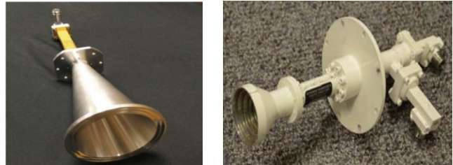
شکل ۶. آنتن شیپوری نمونه‌بردار باند Ku، الف) SN 401، ب) SN 1057 [۱۷]
