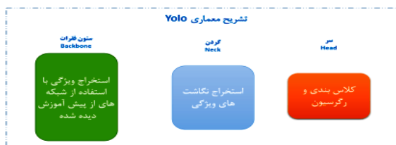
شکل ۱۲. بخش‌های مختلف شبکه YOLO [۲۲]
