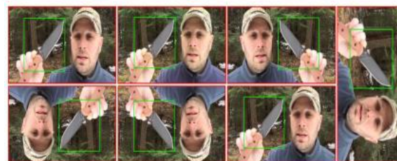
شکل ۲۰. نمونه تصاویر افزایش داده‌ها (چرخش عمودی، افقی، تغییر شدت رنگ، تار کردن و...)
