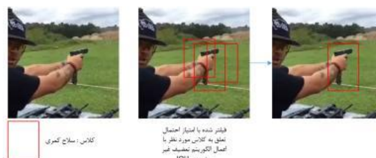
شکل ۳. تعریف لنگر برای شیء خاص و تشخیص شیء بعد از اعمال عملیات متناسب تعریف شده
