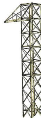
شکل ۶. نمای سه‌بعدی دکل مقیاس شده در تحقیقات آزمایشگاهی لی و مک کلور [۹].
