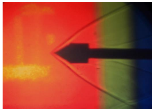
شکل ۱۰. نمایش تلفیق با و بدون لیزر مدل نوک تیز در ماخ ۳/۴
