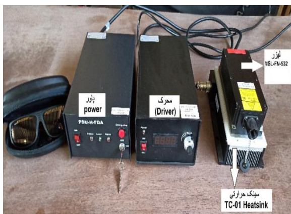
شکل ۲. چیدمان لیزر MSL-FN-532-S
