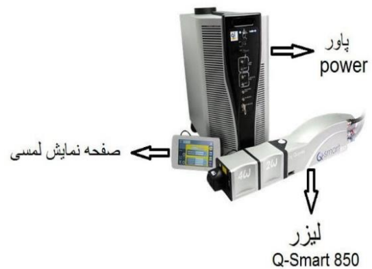
شکل ۴. شمایی از چیدمان لیزر کیو اسمارت ۸۵۰
