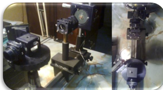
شکل ۹. شکل چیدمان به‌کاررفته، ۱- لیزر دیود ۲- پرتو گستر ۳- جداکننده ۴- آینه ۵- قطبش‌گر.
