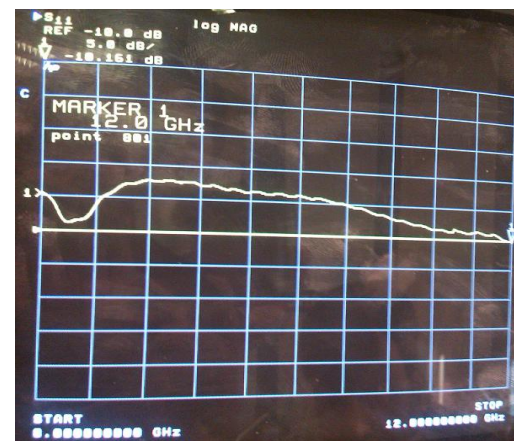
شکل ۱۴. نمایش طیف جذبی F-P(۲۵-۷۵) با ۹۰٪ اپوکسی و ضخامت ۱ mm
