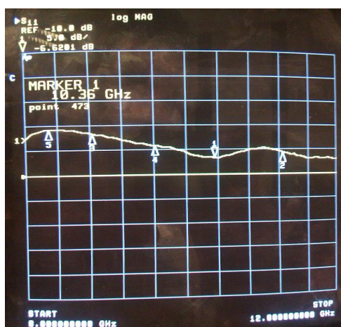
شکل ۱۲. نمایش طیف جذبی Mn-Zn، با ۹۰٪ اپوکسی و ضخامت ۱ mm
