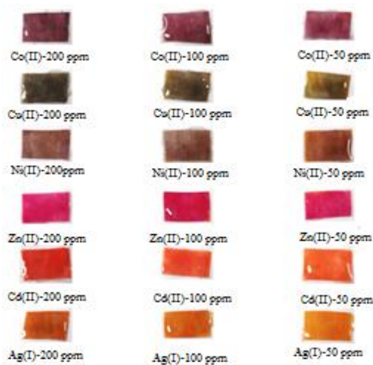
شکل ۷. نتایج تجربی مربوط به تأثیر غلظت محلول یونی بر آشکارساز یون فلزی
