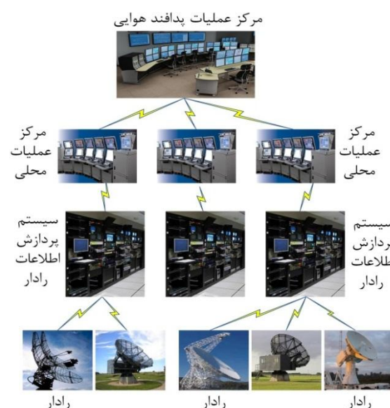
شکل ۱. ساختار کلی شبکه فرماندهی و کنترل
