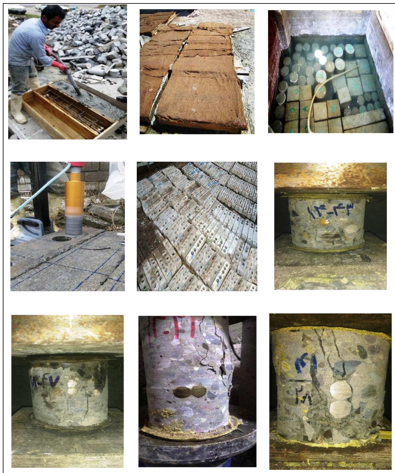
شکل ۱. مراحل انجام ساخت تیرها، عمل آوری، مغزه گیری از تیرها و آزمایش مغزه ها در ابعاد مختلف با چیدمان مختلف میل گرد ها
