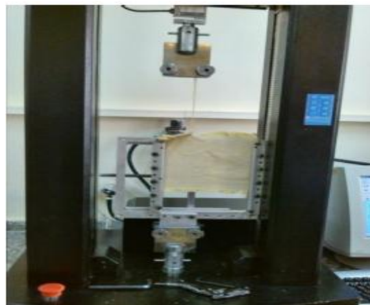
شکل ۲. آزمون بیرون‌کشی الیاف
