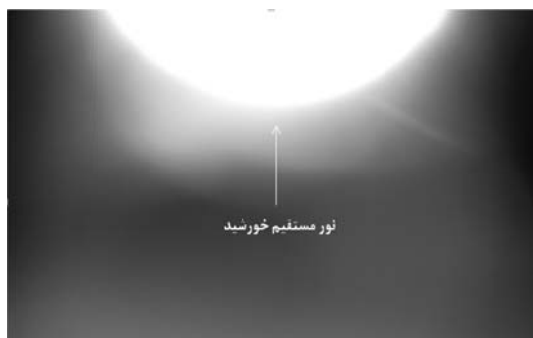
شکل ۱. نورهای سرگردان حاصل از خورشید که به دلیل کوتاه بودن سپر اپتیکی، منجر به درخشندگی ایجاد شده در تصویر شده است [۹]
