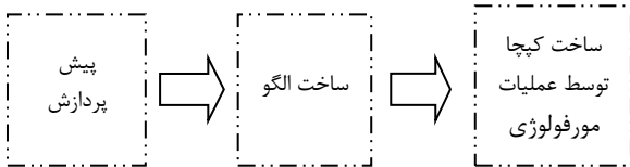
شکل ۵. روند نمای تولید کپچای تصویری با استفاده از مورفولوژی
