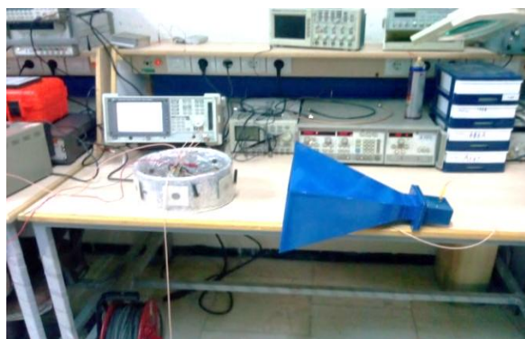
شکل ۲۷. آزمایش عملکرد آنتن هوشمند از نمای روبه‌رو
