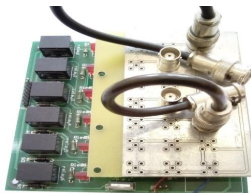
شکل ۲۴. نحوه اتصال کانکتورها به مدار اصلی توسط مدار طبقه دوم
