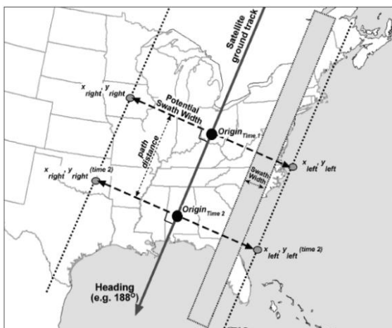
شکل ۳. نقشه تصویر آزمایش‌های مساوی که هر نقطه ماهواره نشان دهنده مرکز تصویر است. پوشش تصویری و زاویه مسیر ماهواره در شکل مشخص شده است [۲]
