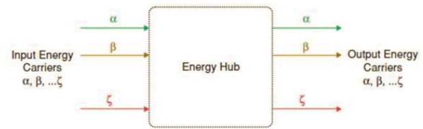
شکل ۱. مدل‌سازی قطب انرژی به عنوان واسطه‌ای میان چند حامل ورودی انرژی و بارهای سامانه
