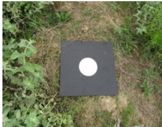
شکل ۴. نمونه‌ای از تارگت‌های ۱۰ سانتی‌متری طراحی شده در آزمون عملی
