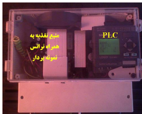
شکل ۱۴. کنترل کننده ساخته شده با استفاده از PLC
