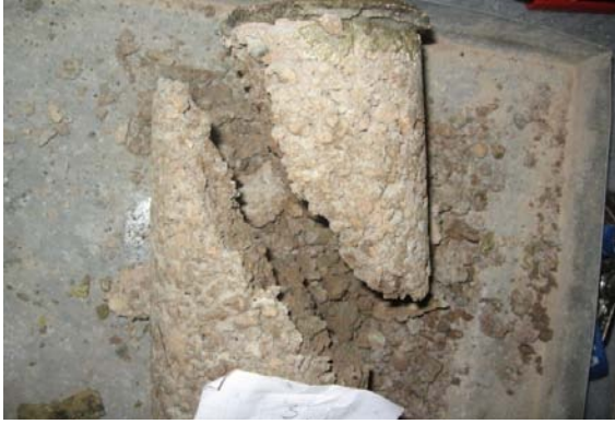
شکل ۳. یک نمونه شکسته شده با زاویه تقریباً ۴۵ درجه [۱۷]
