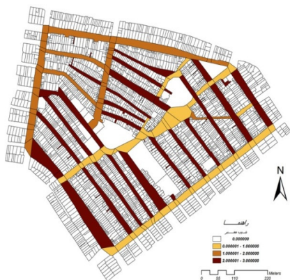
شکل ۶. میزان کارایی شبکه با توجه به شیب معبر
