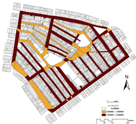
شکل ۵. میزان کارایی شبکه با توجه به قوس معبر
