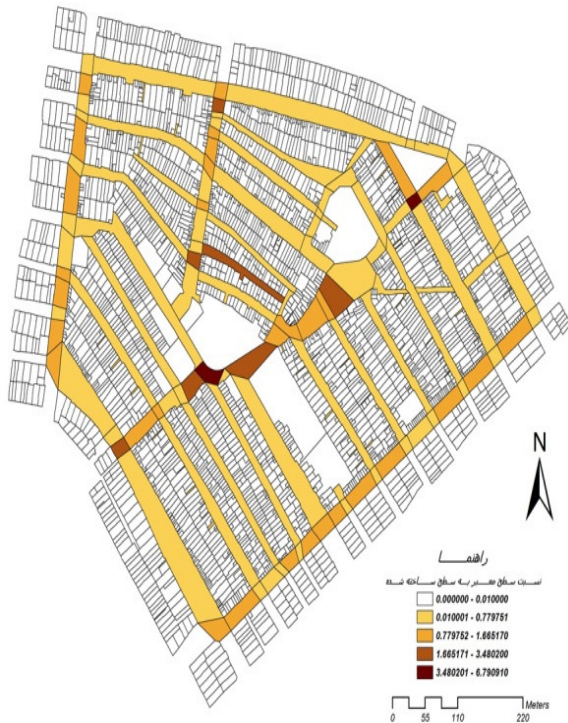
شکل ۳. میزان کارایی شبکه با توجه به نسبت سطح معابر به سطح ساخته شده
