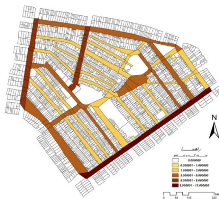
شکل ۸. میزان کارایی شبکه با توجه به تعداد گره و تقاطع
