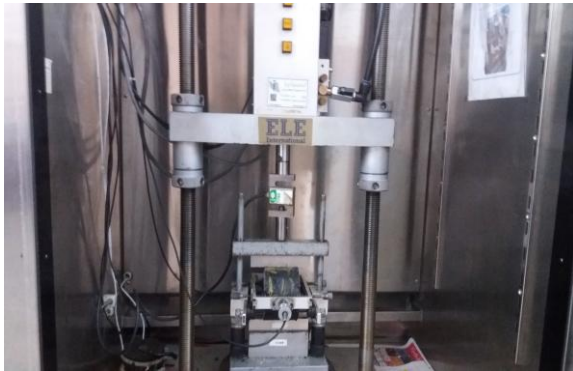
شکل ۵. انجام آزمایش مدول برجهندگی بر روی نمونه‌ها
