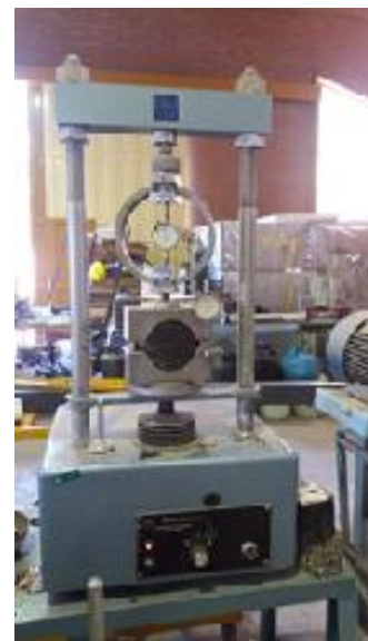
شکل ۴. انجام آزمایش مقاومت مارشال بر روی نمونه‌ها
