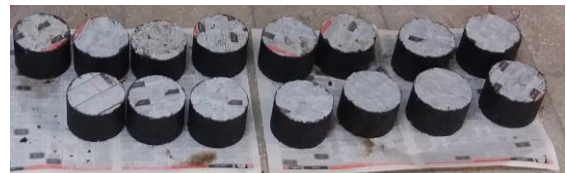
شکل ۳. نمونه‌های آسفالتی تهیه‌شده توسط دستگاه ژیراتوری
